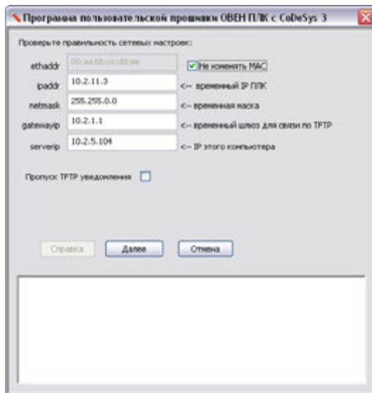
Рисунок Д.2 – Вид окна настройки сетевых интерфейсов для смены встроенного ПО ПЛК
