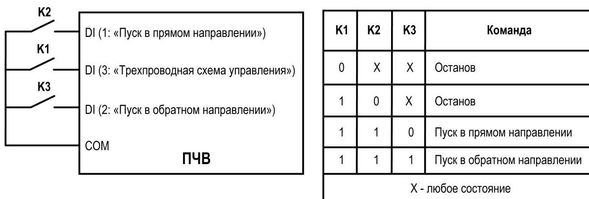
Рисунок 6.4 – Режим управления “Трехпроводная схема 2”
